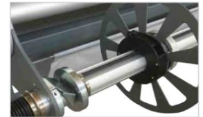
直径400mm、最大90kgのロールに対応する ための高耐久シャフト(オプション)
